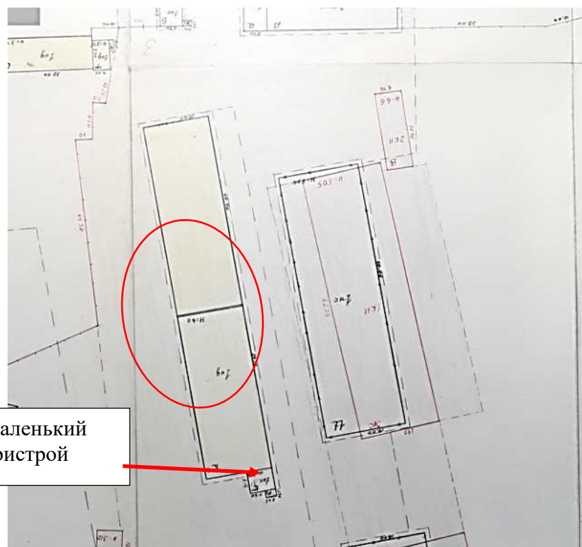
22. ОКС 41:01:0010112:249, адрес: Камчатский край, г. Петропавловск-Камчатский, ул. Приморская, д. 104, назначение: нежилое здание (контора). Желтой линией выделена оставшаяся часть от конторы. Внешние границы ОКСа на местности полностью отсутствуют.
