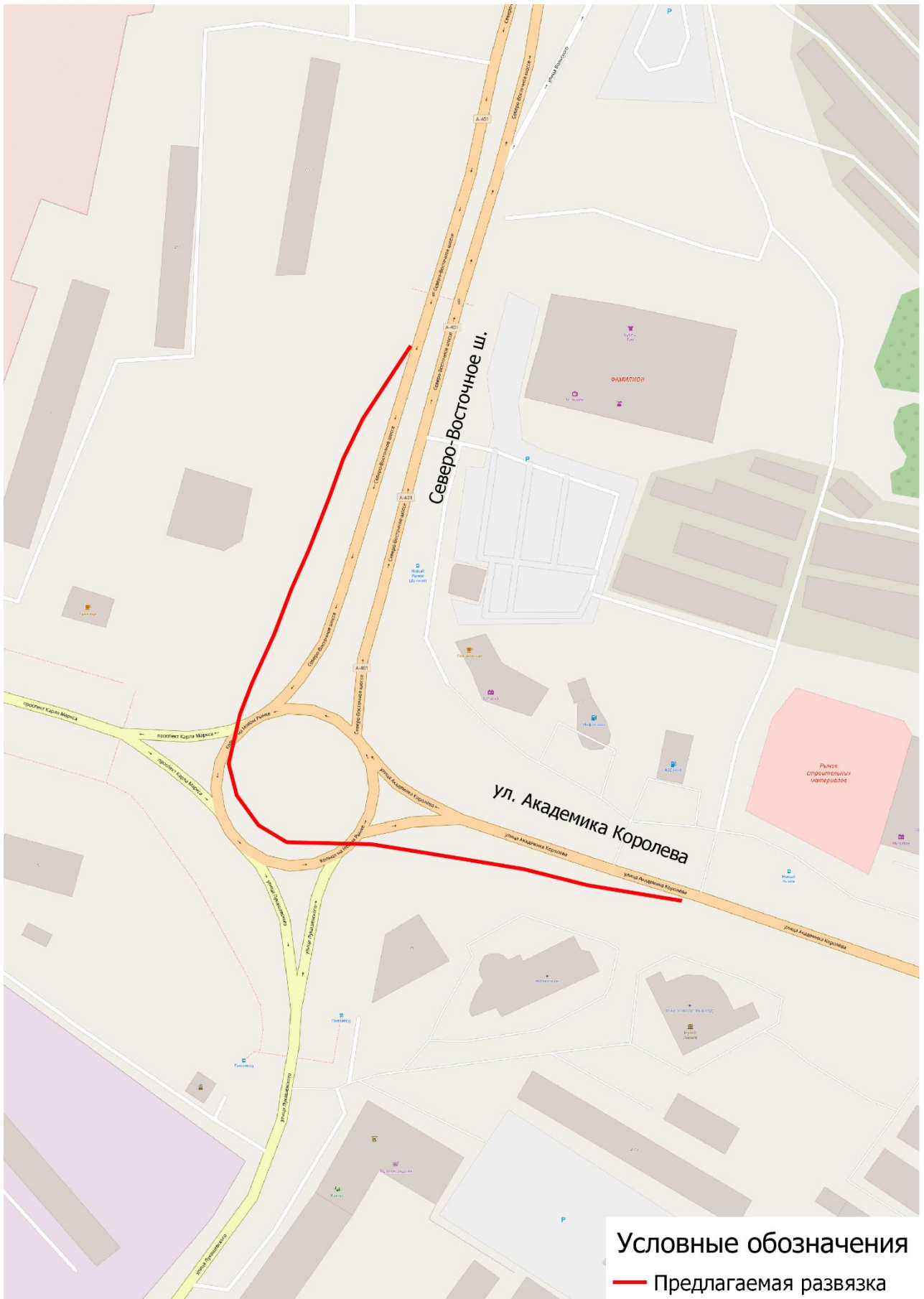
Рисунок 3.12.1 – Строительство однополосного автомобильного путепровода для безостановочного съезда с ш. Северо-Восточное на ул. Академика Королева
