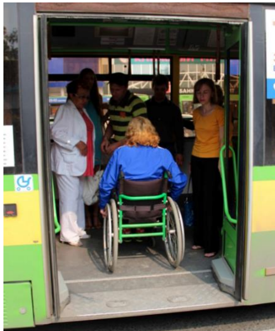
Рисунок 3.19.10 – Отсутствие площадки для представителя МГН в подвижном составе
