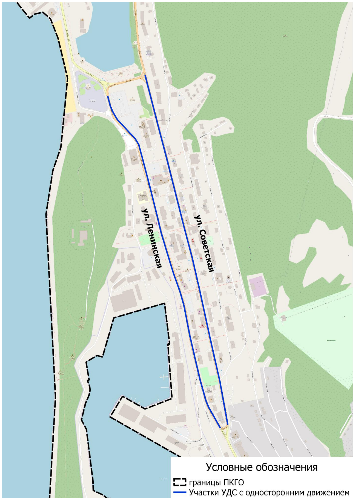
Рисунок 2.5.1 – Схема организации одностороннего движения транспортных средств на дорогах или их участках в существующих условиях
