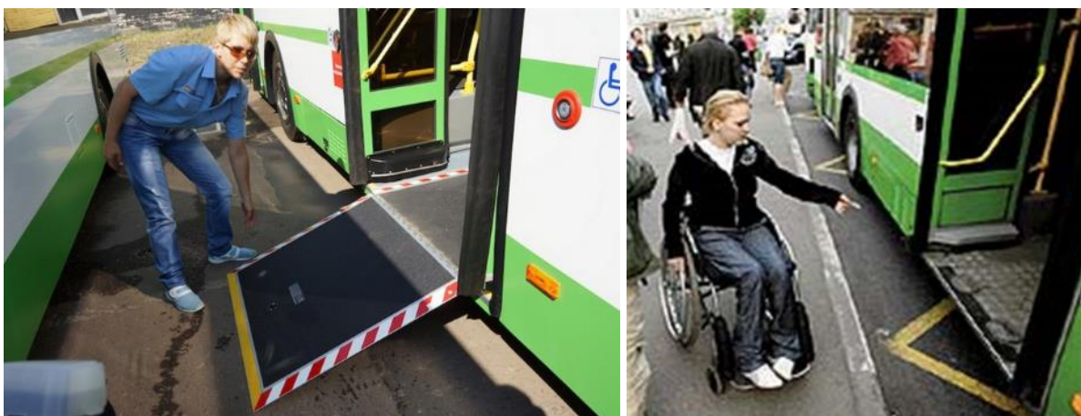
Рисунок 3.19.9 – Зазор между транспортным средством и бортовым камнем о.п.
